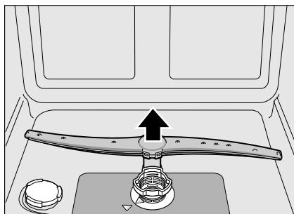
3. Промойте распылительное коромысло в проточной воде.
